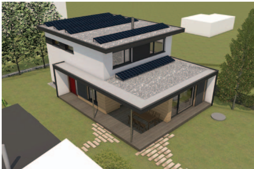
Fotovoltaické panely v nízkém sklonu 15 stupňů
