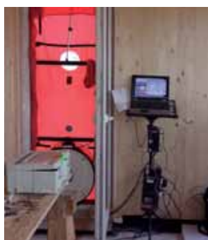
Osazení ventilátoru do dveří
